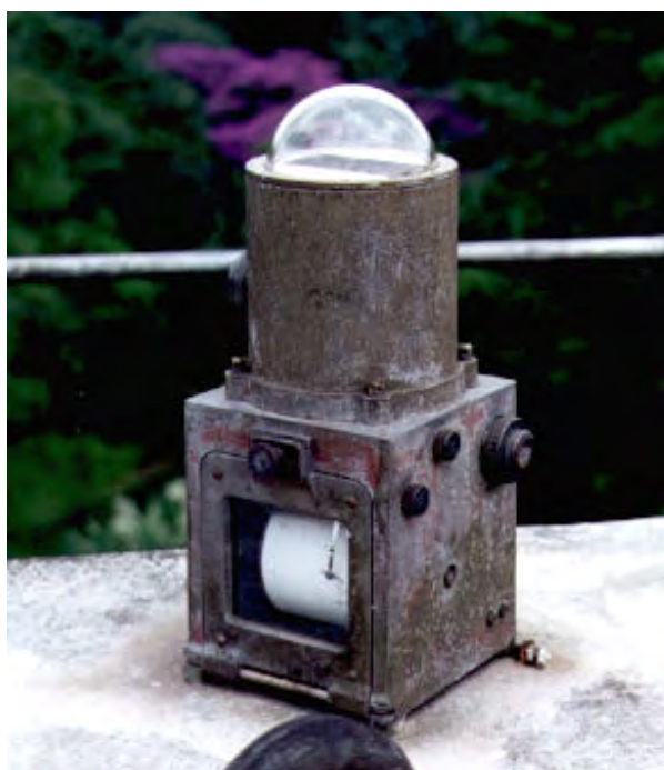
Figura 3.9. Fotografia de um Actinógrafo tipo Robitzsch-Fuess em operação no IAG/USP - Água Funda há mais de 35 anos.
