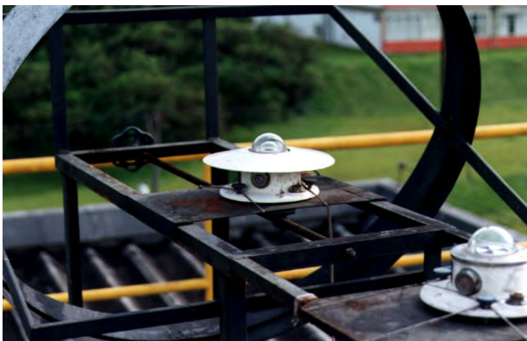
Figura 3.10b. Fotografia de um Piranômetro tipo branco e preto, realizando medidas da irradiação global e outro termoelétrico de precisão tipo psp, realizando medidas da irradiação difusa (notar a presença de anel sombreador) no IAG/USP - São Paulo.
