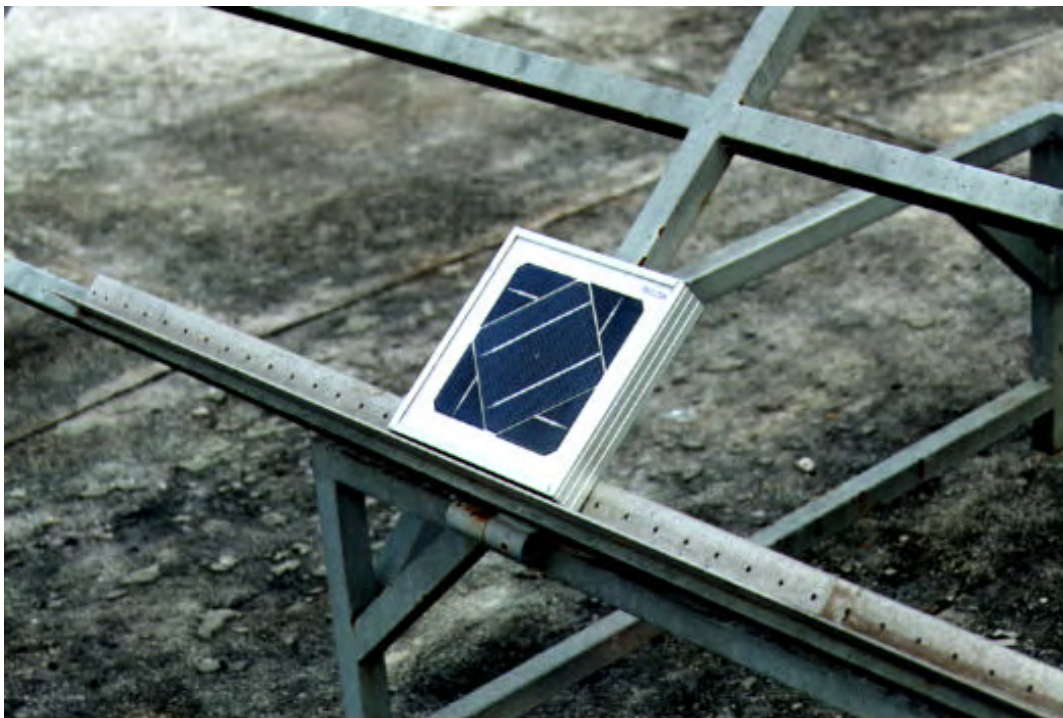
Figura 3.10a. Fotografia de um Piranômetro fotovoltaico.
