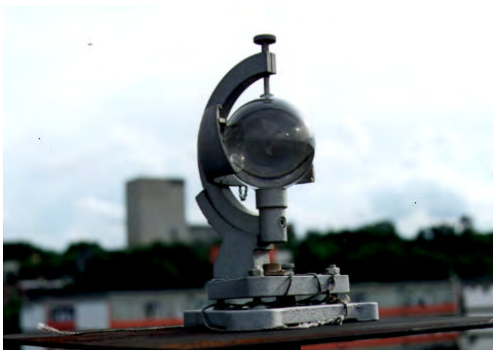
Figura 3.8. Fotografia de Heliógrafo instalado no IAG/USP - São Paulo, apenas para demonstração.
